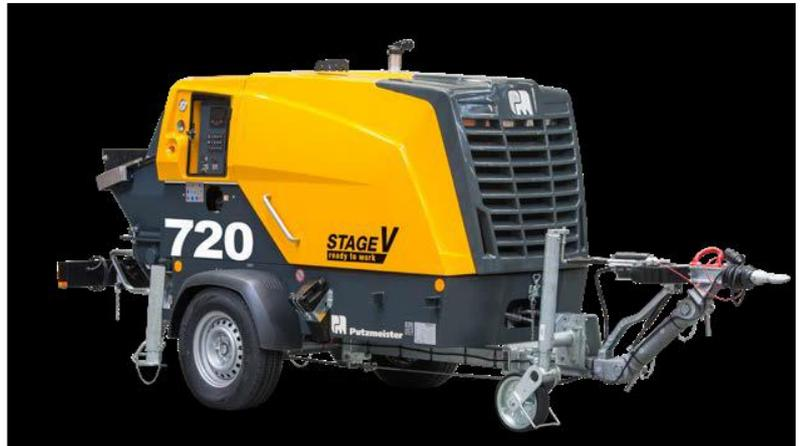
Die P 720 fördert pumpfähige Medien bis zu 16 mm Korngröße zuverlässig über große Entfernungen. Die leistungsstarke Kolbenpumpe ist ideal für Spritzbeton- und Fließestricheinsätze. Sie ist ein echter Allrounder mit bis zu 80 bar Förderdruck und 21 m<sup>3</sup>/h Förderleistung bei gleichzeitig geringen Abmessungen und niedrigem Gewicht.
